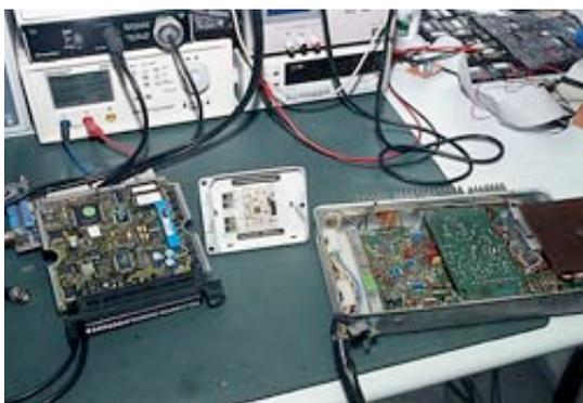
**Die Spanne der Motorsteuergeräte, die Hitzing & Paetzold diagnostizieren und instand setzen kann, ist vielfältig: (v. li.) VW ME Motronic von 1997, Opel M155 Motronic von 2001 und Mercedes-Benz L-Jetronic von 1969.**
